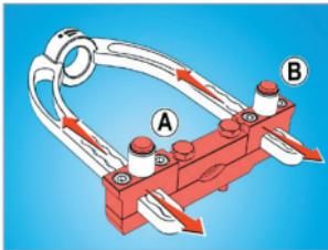
Pred vpetjem v primež (po potrebji) nastavite ogrodje držala, z pritiskom dveh gumbom (A in B) na pravilno dolžino vratu zgloba
