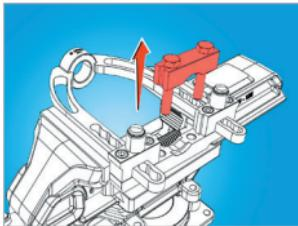
Demontiramo zgornje nastavljivo vo držalo (držalo ima dva vijaka S17) • Dismount the upper adjustable holder (the holder has two screws S17).
