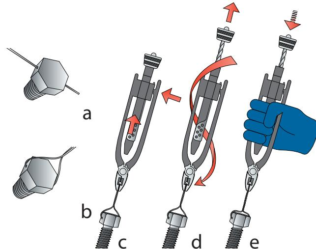
Double-twist safety wiring (right-handed/left-handed thread) / Dvojno varnostno ožičenje vijakov (desni/levi navoj)
